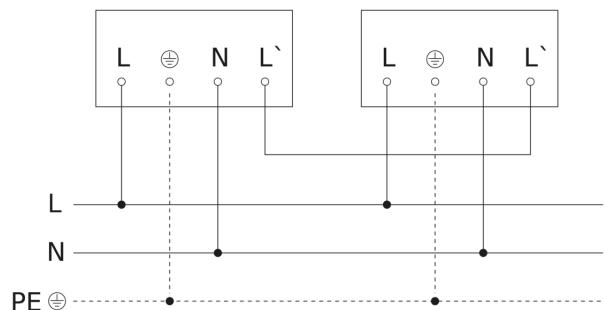
Schéma du circuit d'interconnexion maître/esclave
